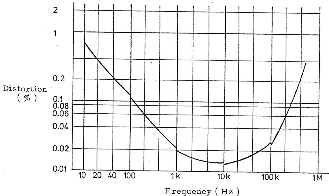
Output voltage : maximum, load :  $600\Omega$ , ambient temperature :  $25^\circ\text{C}$
