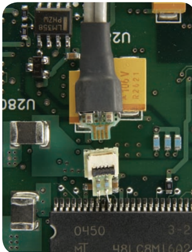
InfiniiMax ZIF tip soldered on board
